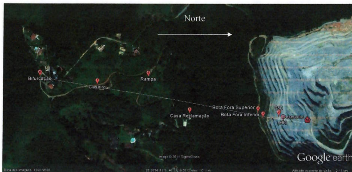
Figura 8- Pontos de posicionamento dos sismógrafos
